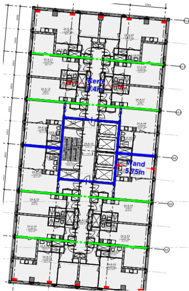
Figuur 52 Gekozen oplossing voor stabiliteitssysteem
