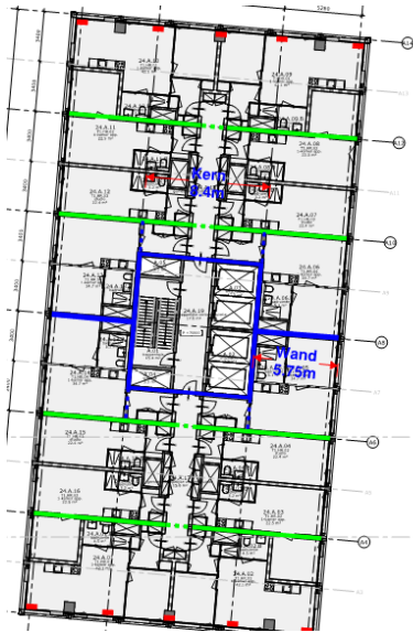
Figuur 2 Gekozen oplossing voor stabiliteitssysteem
